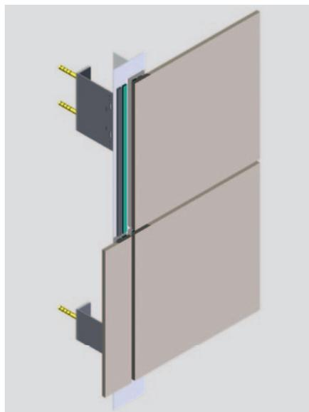
Fissaggio a scomparsa con ancoranti sottosquadro
